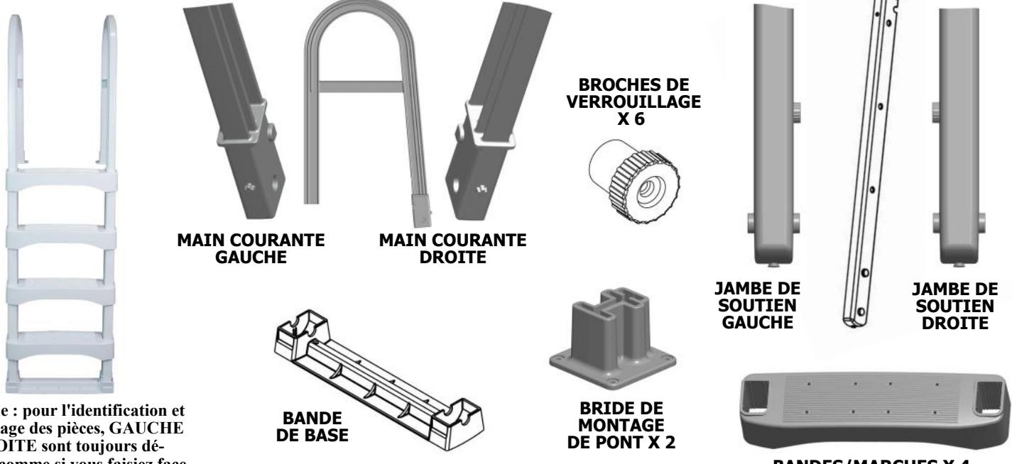
Remarque : pour l'identification et l'assemblage des pièces, GAUCHE et DROITE sont toujours déterminés comme si vous faisiez face à l'échelle sur le point de monter.
